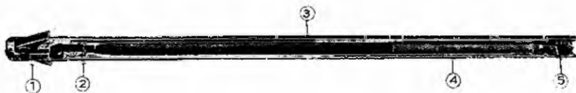
Fig. 18.7 - Cilindro Cardox: 1) testa di scarico con griffe; 2) disco tarato; 3) corpo del cilindro; 4) miscela in un tubo di carta; 5) testa di accensione
