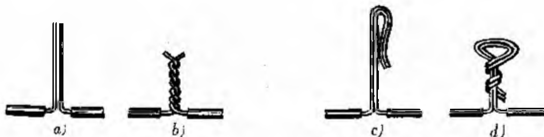
Fig. 9.17 - Giunzione di due reofori: a), estremità avvicinate indi, b), avvolte a spira; oppure c), estremità vicine ripiegate indi, d), avvolte a spira
