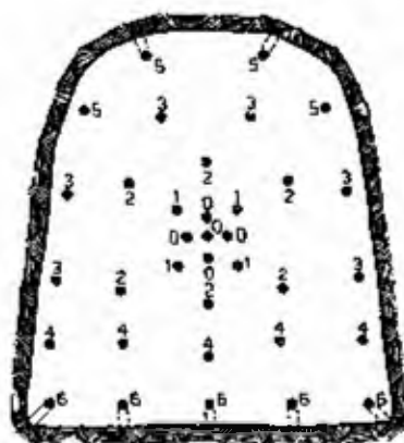
Fig. 16.29 - Tipo di volata di prova con 35 fori
