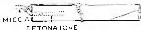
Fig. 8.16 - Miccia fissata con spago alla cartuccia (Coast Manuf. and Supply Co.)
