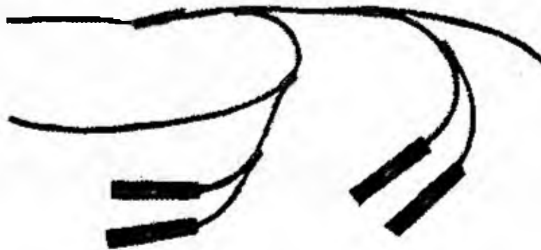
Fig. 8.44 - Collegamento di micce detonanti in parallelo (SIPE)
