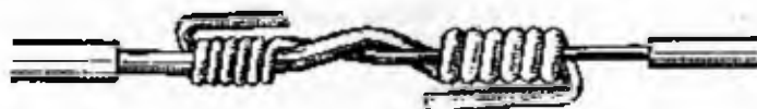
Fig. 9.21 - Collegamento fra conduttore di connessione e linea di tiro, detto tipo telegrafo (Montecatini Edison)
