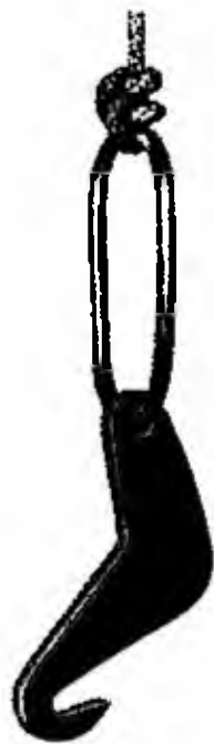
Fig. 13.3 - Corda e gancio a liberazione automatica per la discesa delle cartucce di esplosivo nei fori da mina (Blasters' Handbook, 15 a ed., 1966, Du Pont)
