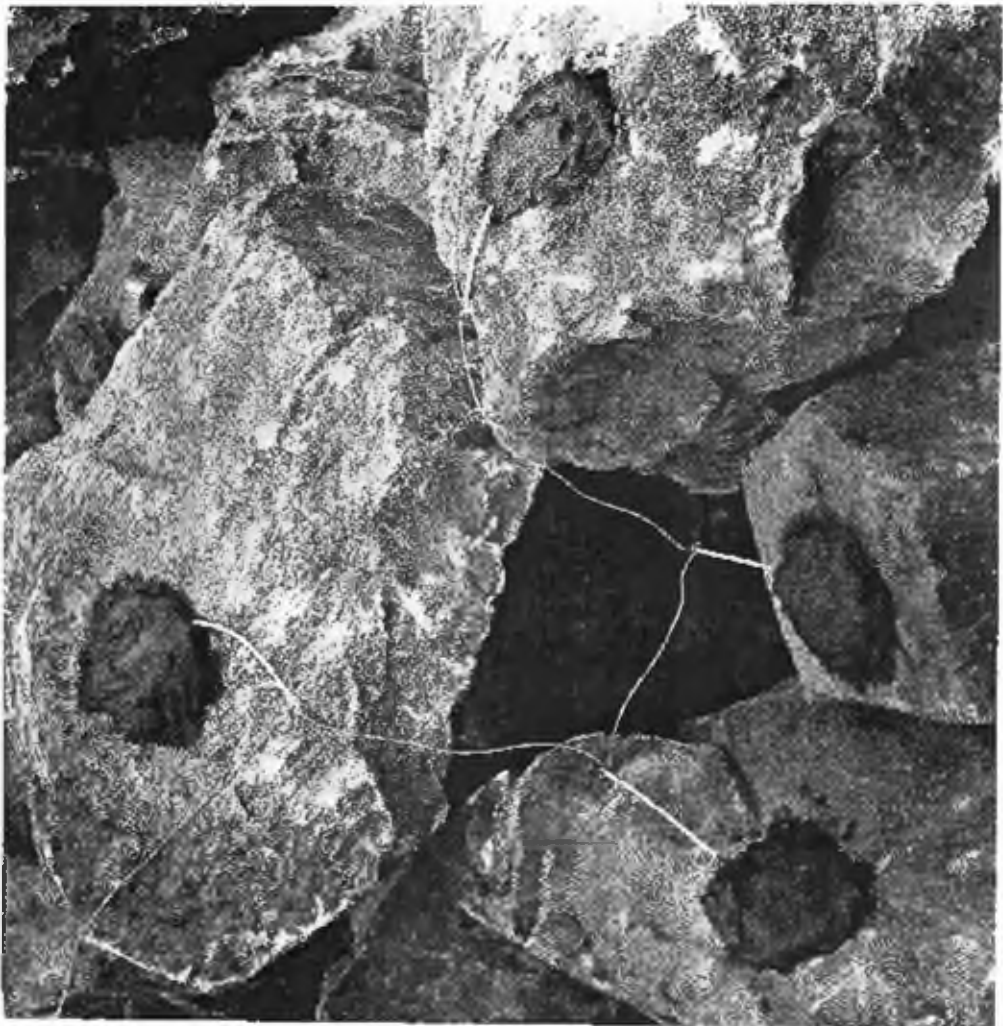
Fig. 17.36 - Petardaggio in volata di blocchi con miccia rapida che collega le singole micce a lenta combustione (Blasting Practice, 3° ed., 1962, Imp. Chem. Industries)
