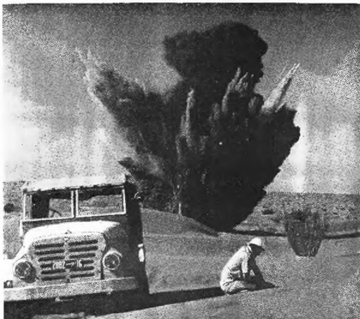
Fig. 17.4 - Brillamento di una carica di 8 kg di esplosivo per sismica a riflessione a El Bonna, Tunisia (Soc. Italo-Tunisienne d'exploitation pétrolière, S.I.T.E.P., del Gruppo Ente Nazionale Idrocarburi, ENI)
