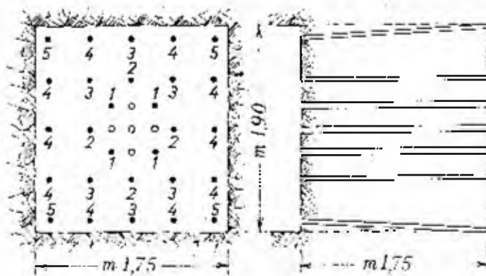
Fig. 6.21 - Tipo di volata completa in avanzamento normale con intesto canadese
