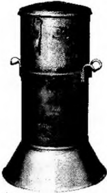
Fig. 8.74 - Recipiente per la imbibizione delle cartucce con ossigeno liquido, di capacità 60 litri, sufficiente per sessanta cartucce (Socoxyl, Briay; foto P. Winckel, Audun - le Tiche, Francia)
