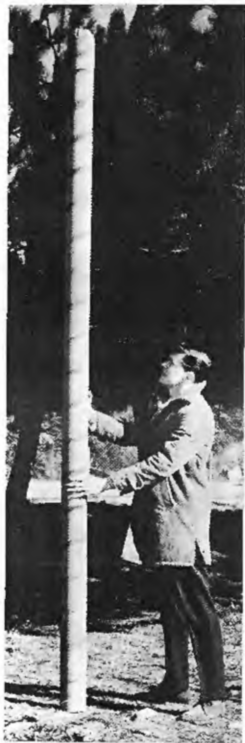
Fig. 17.14 - Cartuccia di dinamite gelatina alta 3,20 m per la stimolazione di orizzonti gassiferi (Hercules Corp.)
