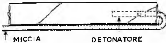
Fig. 8.30 - Curvatura stretta della miccia nell'innescamento posteriore (Coast Manuf. and Supply Co.)
